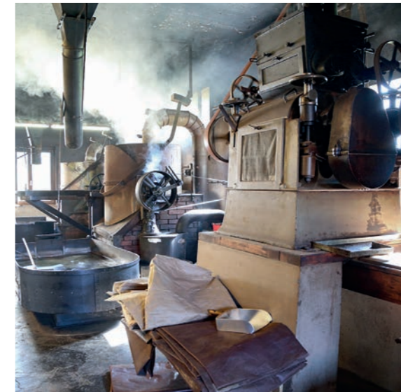
Auf die langjährige Erfahrung von Vater und Sohn von Allmen der Rösterei Cretti in Auw ist Verlass. Gekonnt rösteten sie in ihrer traditionellen Anlage Kaffee und Getreide auf dem offenen Feuer.
